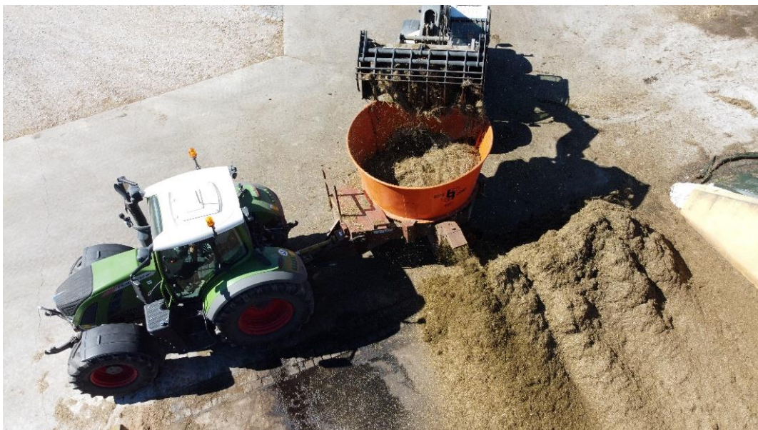
Abbildung 15 Die Stroh­mühle zerkleinert das LPG auf etwa 5 cm.
