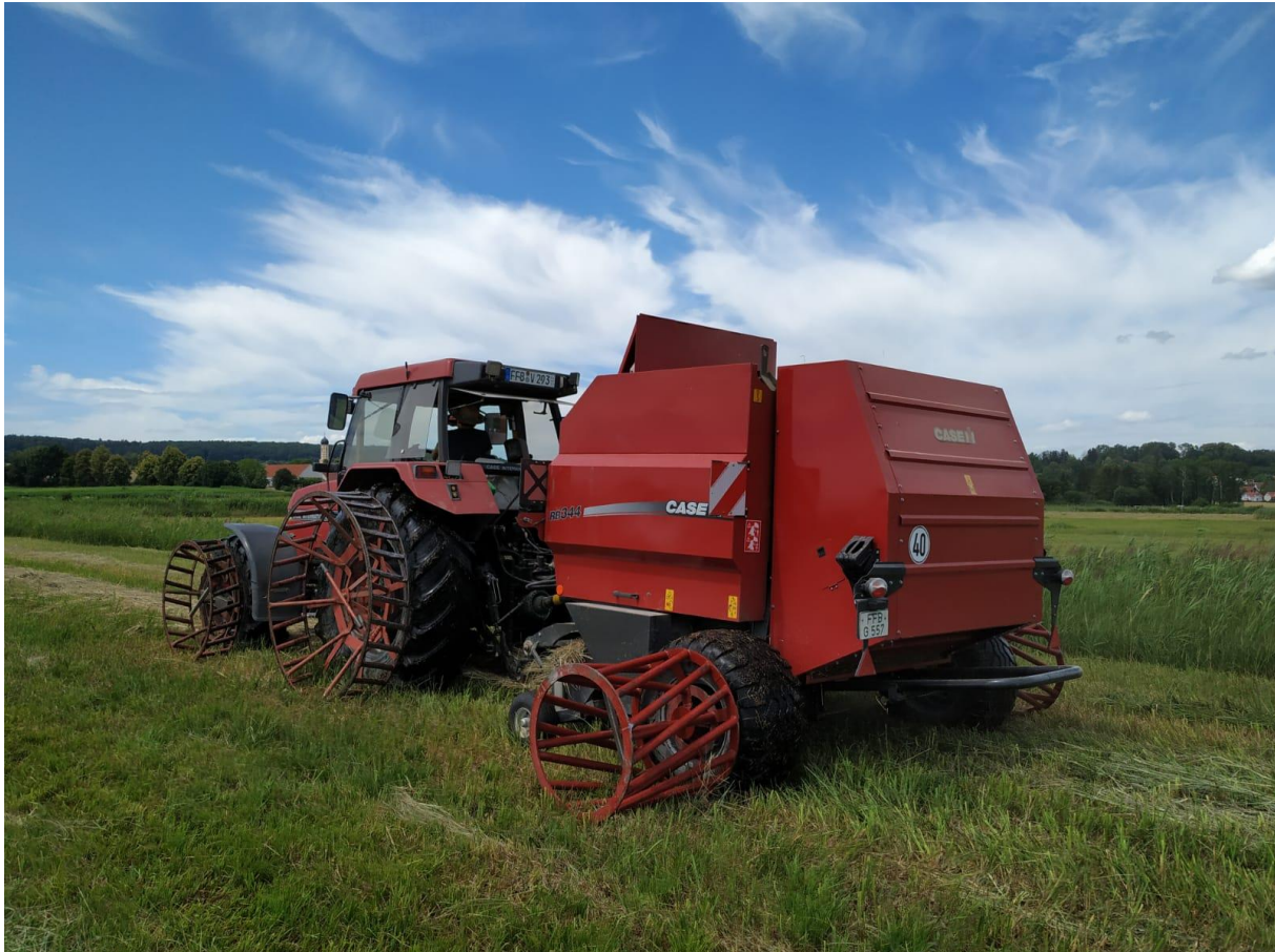
Abbildung 3 Zwillingsbereifung mit Gitterrädern verhindert, dass sich Schlamm vor den Reifen ansammelt.
