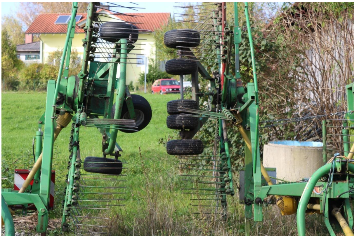
Abbildung 2 Der umgebaute Schwader (rechts) hat im Gegensatz zum konventionellen Schwader (links) alle Räder in einer Achse. Das verbessert die Befahrbarkeit auf unebenem Terrain.
