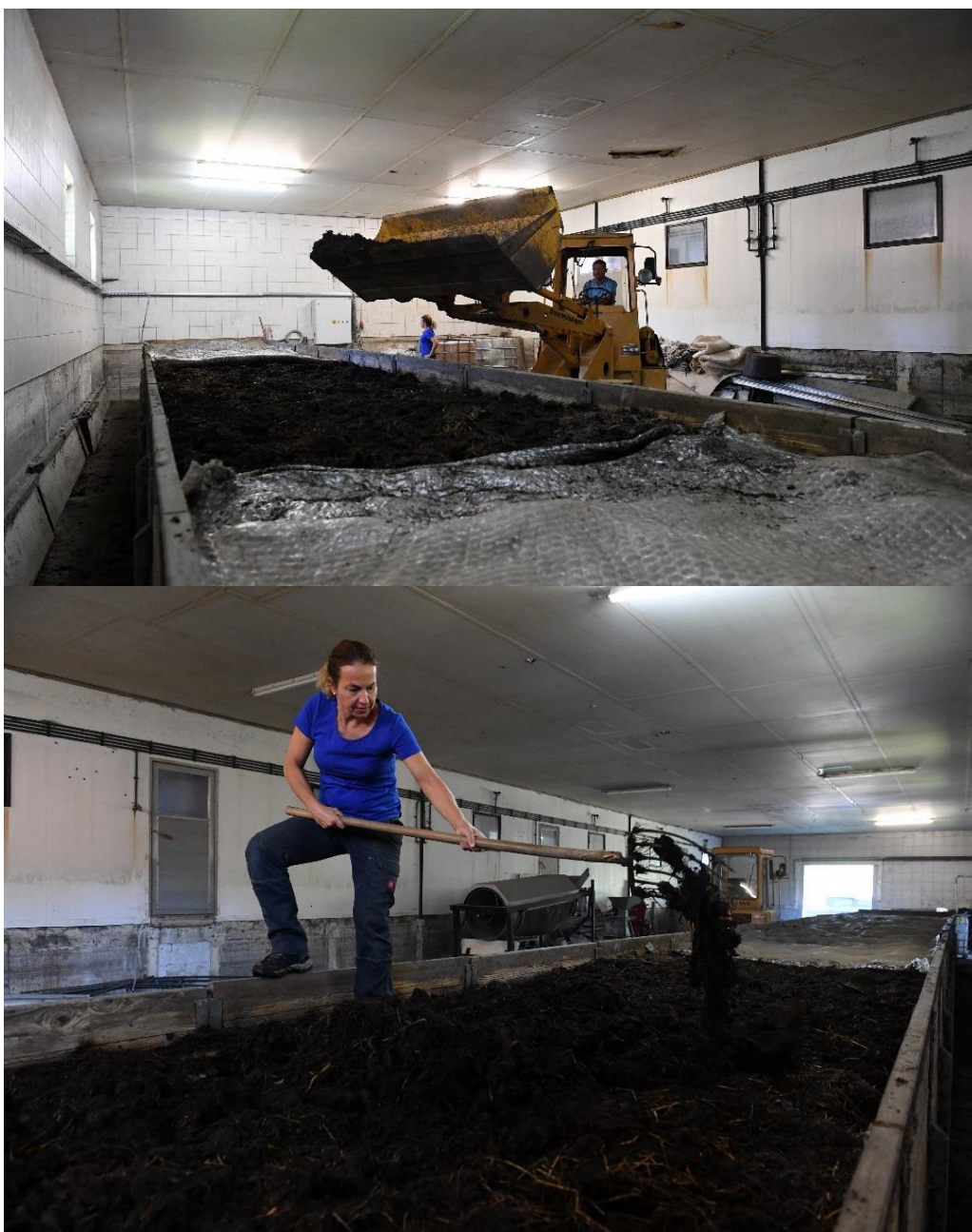
Abbildung 10 Frisches Kompostsubstrat wird mit dem Radlader zugeführt (oben) und mit der Mistgabel verteilt (unten).
