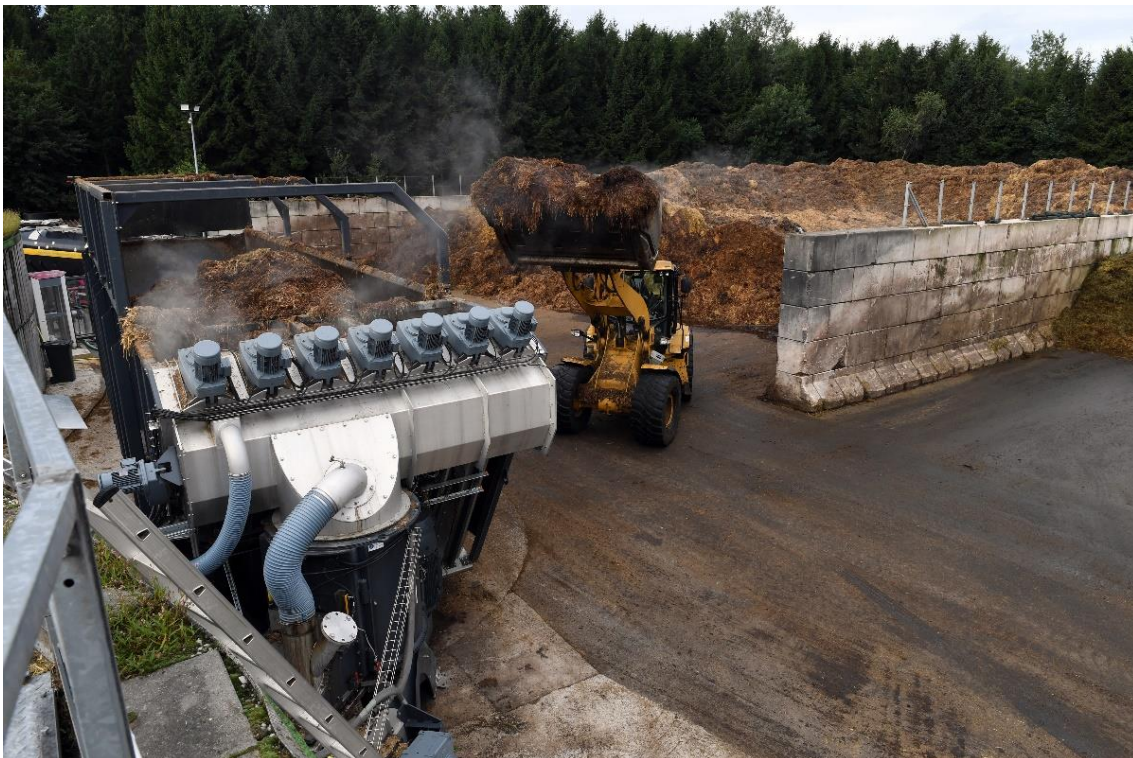
Abbildung 12 Ein Radlader befüllt einen Schredder mit Mist. Der Schredder speist das gekürzte Substrat in den Vorgärer ein.
