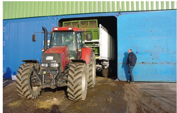
Füllvorgang eines Trockenfermentations Fermenters nach dem TNS-Verfahren der Fa. Loock.
